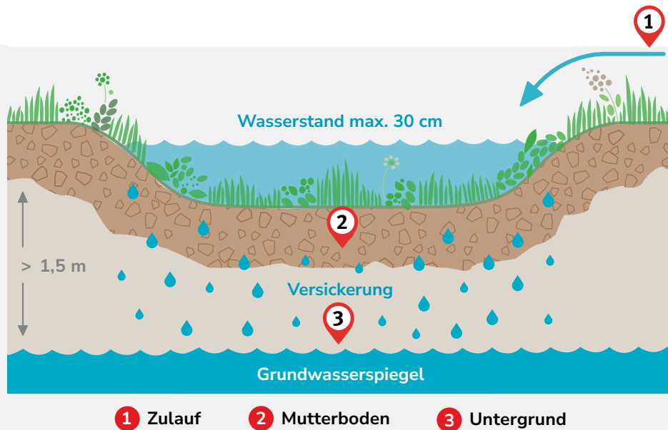
Versickerung des Regenwassers über eine Mulde im Gelände.
